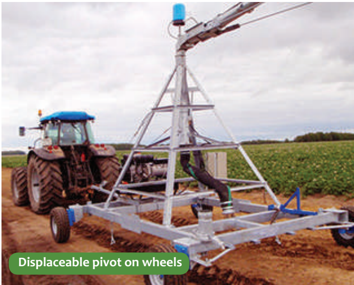
Linear pivot irrigation
